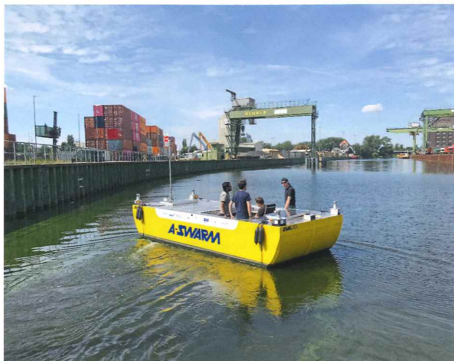
KI übernimmt: Autonome Binnenschiffe könnten eine Antwort auf Straßenstaus sein. Christian Masilge (kl. Bild, links) von der Schiffbau-Versuchsanstalt Potsdam (SVA) steuert via Computer einen Prototypen im Becken I des Berliner Westhafens mit schwimmenden Reflektoren zwecks Hinderniserkennung.
