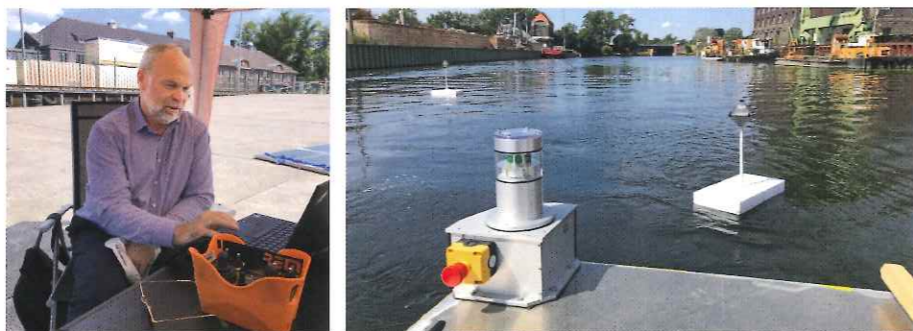
KI übernimmt: Autonome Binnenschiffe könnten eine Antwort auf Straßenstaus sein. Christian Masilge (kl. Bild, links) von der Schiffbau-Versuchsanstalt Potsdam (SVA) steuert via Computer einen Prototypen im Becken I des Berliner Westhafens mit schwimmenden Reflektoren zwecks Hinderniserkennung.
